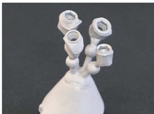
• Вид после завершения процесса литья.
