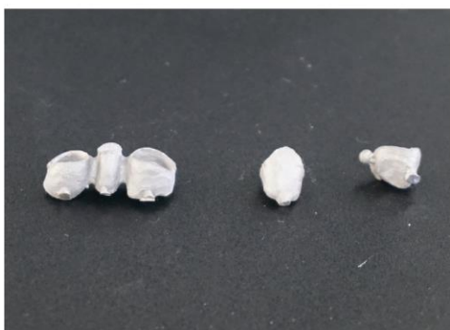
• Вид после завершения срезания литниковой системы.
