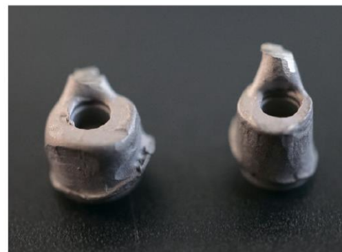
• Вид после завершения срезания литниковой системы.
